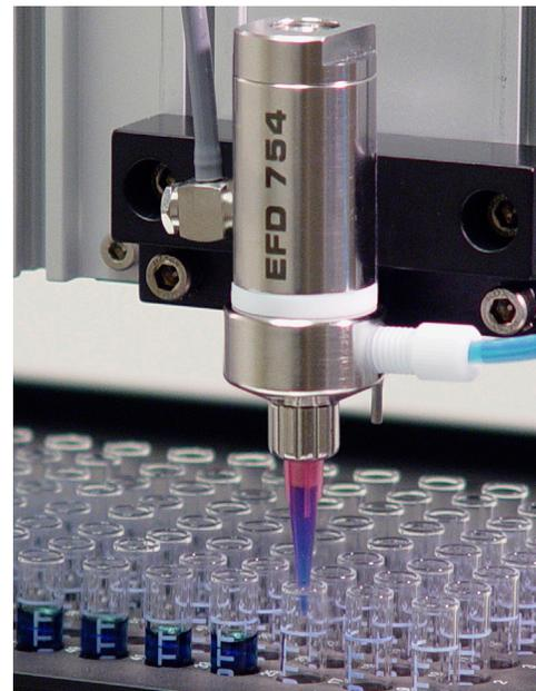
Operazione di riempimento fiale con valvola 754V-SS.
