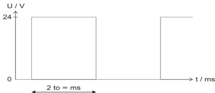
Oszillogramm (Ventilausgang) eines Liquidyn P-Jet Ventils
