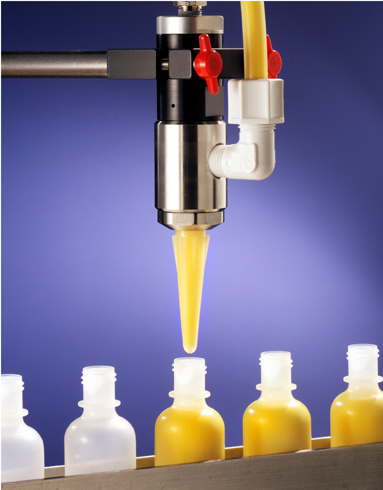
La válvula de alto flujo 725HF-SS dispensa pintura en botellas.
