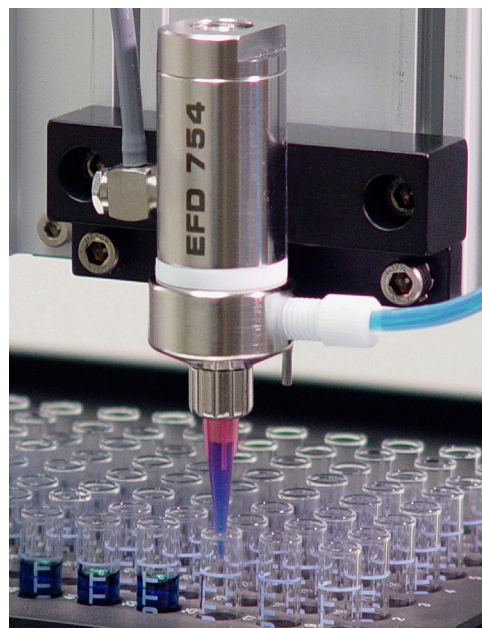
754V-SS 胶阀将流体分配到小瓶中。
