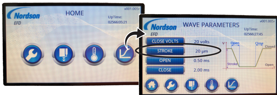
Touch XP 控制器上的 WAVE PARAMETERS 屏幕 (STROKE 单位设置为微米)
