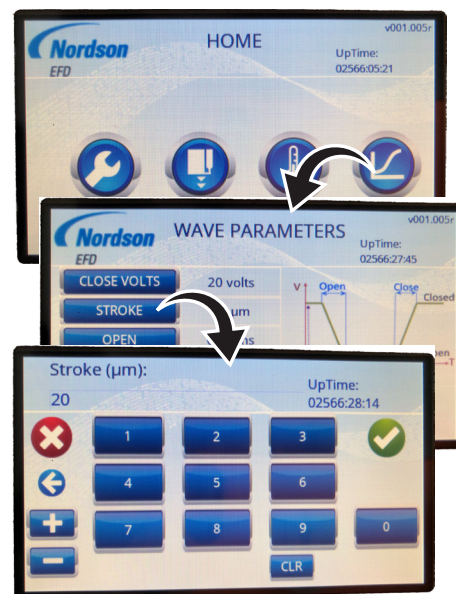
调整启用的波形图的STROKE设置(Touch XP 控制器)
