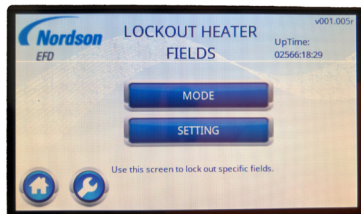
加热模块, 胶阀和波形参数字段的锁定屏幕
