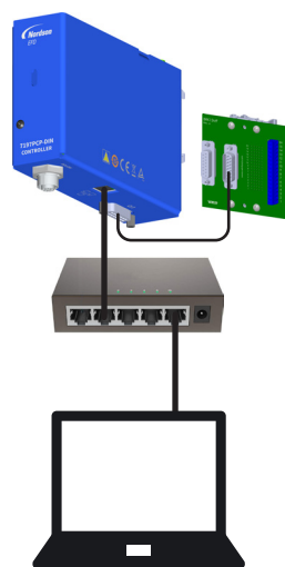
El controlador 7197PCP-DIN permite un control basado en internet de las bombas
