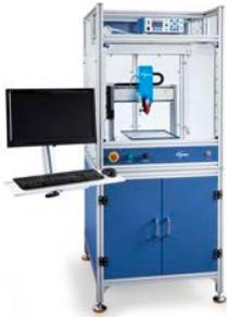
诺信EFD提供的安全防护外罩可以和我们所有的自动点胶平台产品无缝接合。带有外置的点胶控制器，安全光栅和一个可以进行快速安全布线的内部电控箱。这些符合CE标准的安全外罩也同时符合欧盟机械指令2006/42/EC标准。
