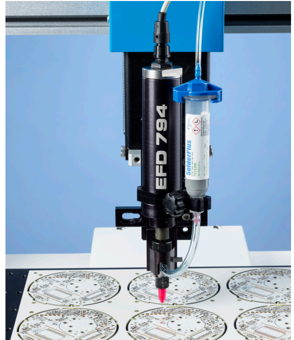
Válvula de barrena 794 y robot dosifican pasta de soldadura en un detector de incendios.
