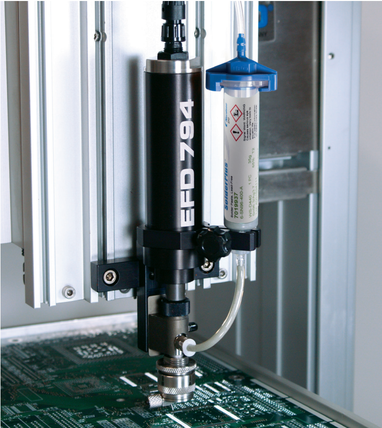
Válvula de barrena 794 dosifica pasta de soldadura EFD.
