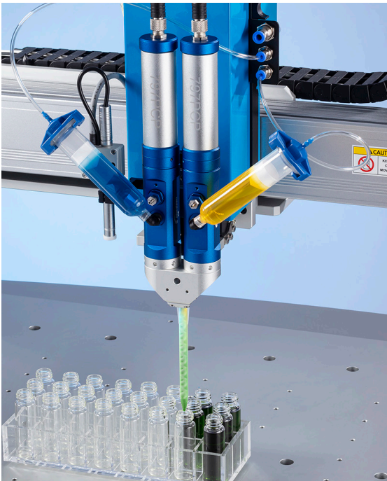
La bomba de cavidad progresiva 797PCP ofrece la mejor repetibilidad y precisión en los volúmenes dosificados con variaciones del \pm 1\% .
