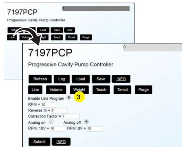
Bildschirm "Linienprogramm", Web-Oberfläche
