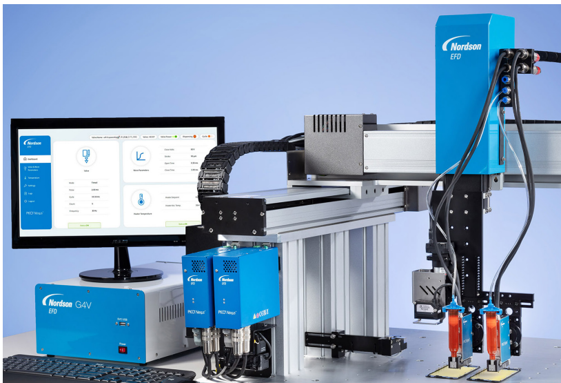
Verwenden Sie die intuitive Webschnittstelle, um Ihr Jetventil entweder vor Ort oder aus der Ferne einzurichten, zu programmieren und zu überwachen.
