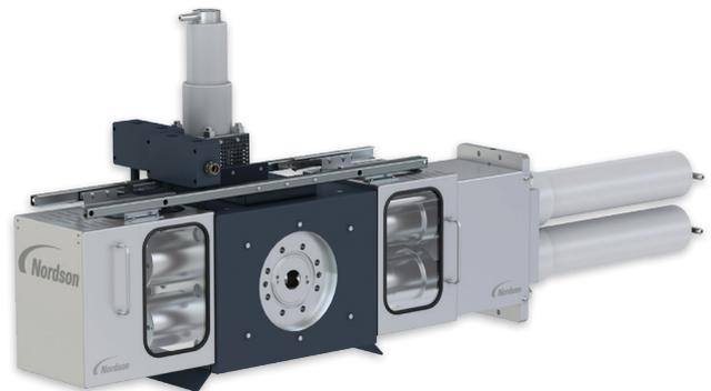
Die neuesten Entwicklungen in der Bolzenfiltrationstechnologie haben große Verbesserungen im Bereich der Druckschwankungen gebracht. Nordsons BKG® V-Typ 3G verfügt über einen Verdrängerstößel, der das benötigte Rückspülmaterial langsam abzieht. Der Schmelzedruck wird so noch konstanter gehalten.
