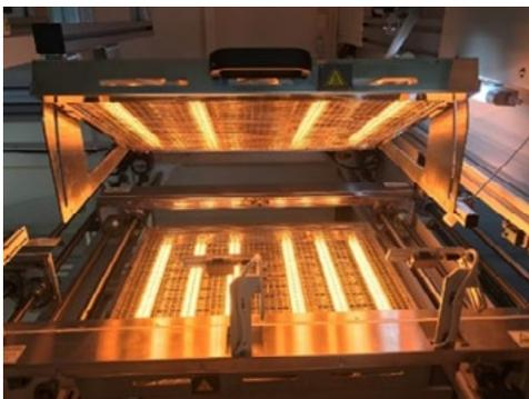
Vorwärmen der Ober- und Unterseite mit Infrarot
