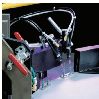
E' possibile controllare fino a quattro valvole in modo simultaneo o indipendente.
