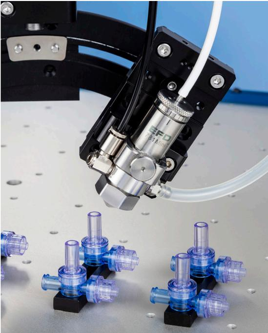
781 Mini-Ventile können in einem Winkel montiert werden, um Material auf schwierige Stellen zu sprühen.
