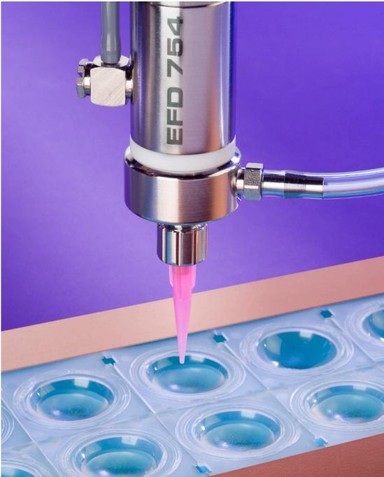
754V-SS Ventil zum Befüllen von Kontaktlinseverpackungen mit Kochsalzlösung.
