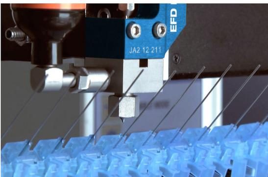
Das Liquidyn® P-Jet-Ventil ist ein pneumatisches Jet-System für Mikrodosierungen ab 3nL.
