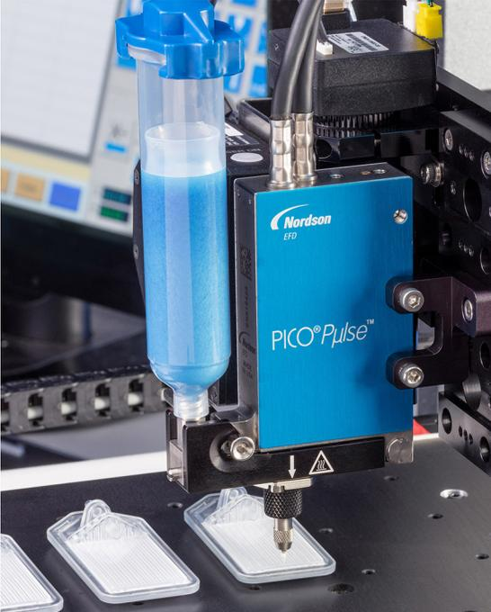
Jet UV-härtet Klebstoffe auf Printplatinen mit höherer Wiederholgenauigkeit aus.
