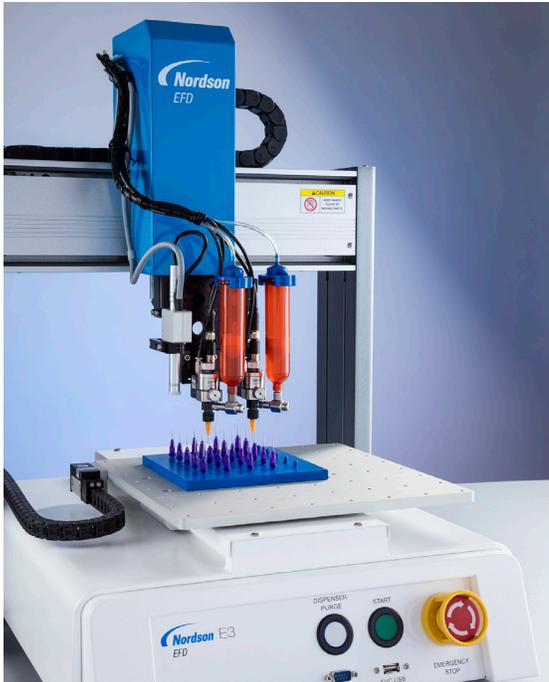
EV-Roboter dosiert UV-Material auf medizinische Komponenten.
