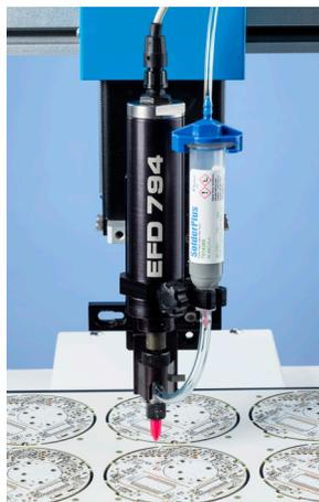
Das 794 Spindelventil dosiert SolderPlus Lotpaste auf einen Feuermelder.
