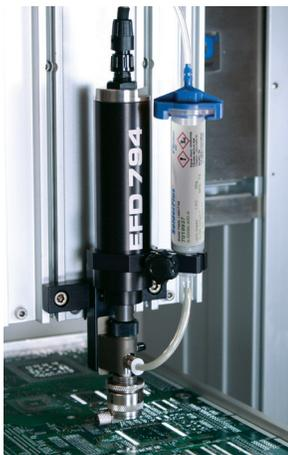
Spindelventil der Serie 794, das die präzise und wiederholbare Dosierung von EFD-Lotpaste auf Leiterplatten ermöglicht.
