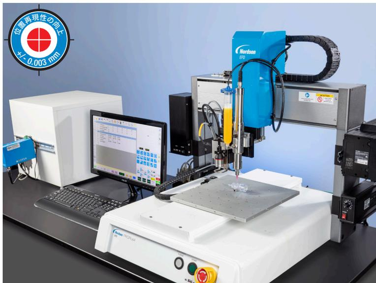
PROXシリーズの作動速度向上と、メンテナンス工数の削減を実現する非接触リニアモーター
