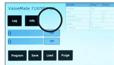
Pantalla Main (Principal) cuando la función de bloqueo / desbloqueo está deshabilitada (sin icono de bloqueo ni botón de desbloqueo)
