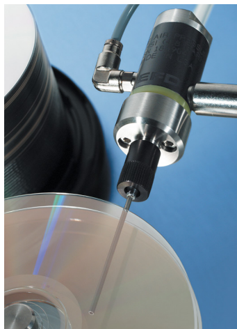
752HF applica resina a polimerizzazione UV per il bonding di DVD.
