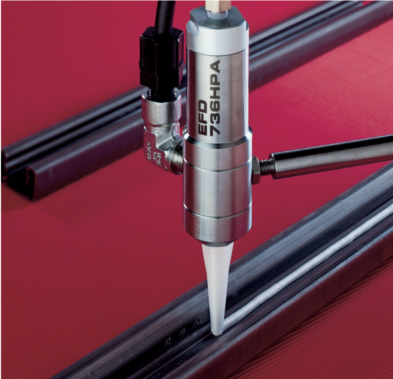
Aplicando RTV en cierres para la industria automotriz.
