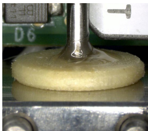
有问题的Pulse驱动器 (有流体进入)
