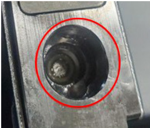
胶阀驱动器推杆腔UV胶污染的示例
