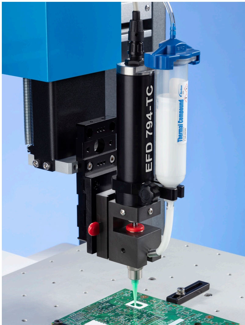
794-TC 胶阀为导热材料的精密、可重复点涂而设计。
