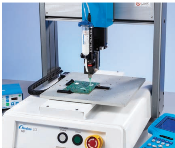
La valve à vis sans fin 794-TC est conçue pour réaliser des déposes et des motifs précis et répétables de matériaux d'interface thermique.
