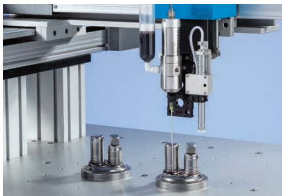
La valve 736 dépose de la graisse sur le couvercle d'une pompe à carburant
