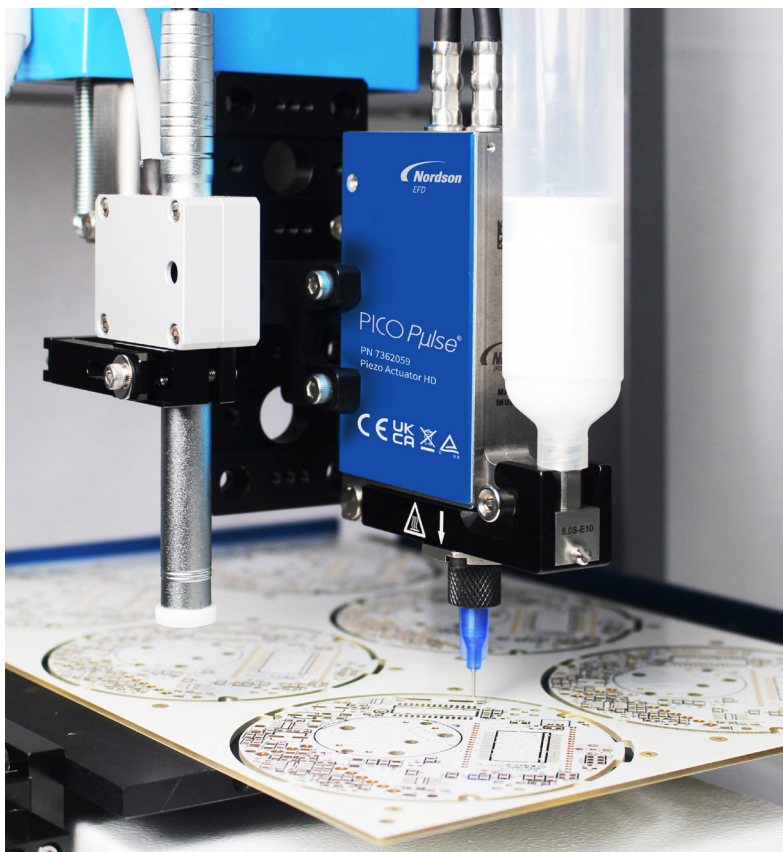
La valve de dosage avec contact PICO Pulse assure une dépose précise à hautes cadences.
