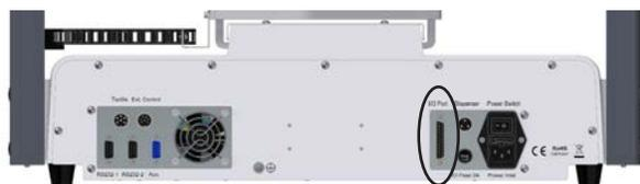
Lage des E/A-Anschlusses am Roboter (PROPlus/PRO-Serie abgebildet)
