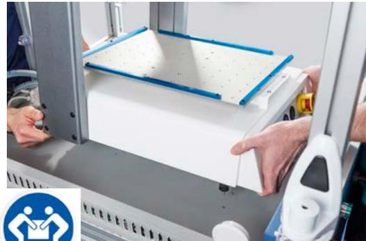
7. Öffnen Sie die Gehäusetüren und ziehen Sie die zuvor entfernten M5-Muttern mit einem Gabelschlüssel wieder an, um den Roboter am Gehäuse zu befestigen.
