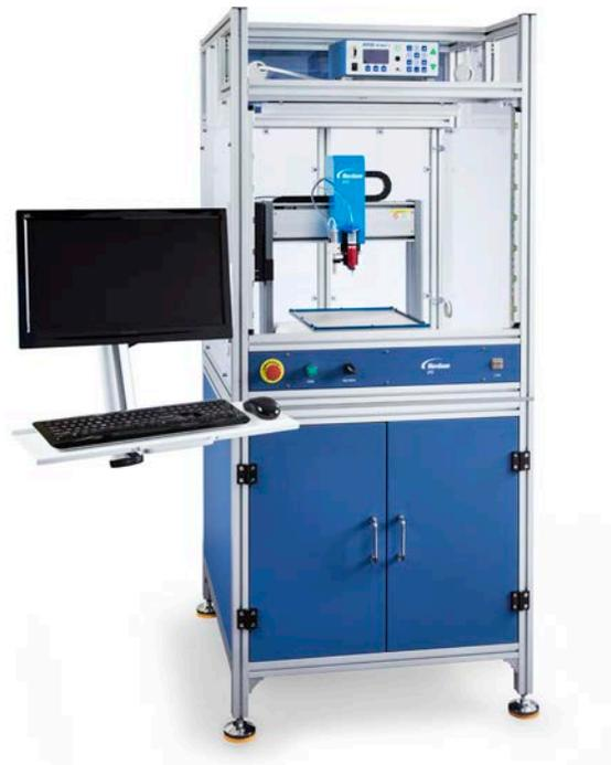
*CE-konformes Sicherheitsgehäuse mit installiertem automatisiertem Dosiersystem (abgebildet ist ein System der EV-Serie mit Standard-Sicherheitsgehäuse)*
