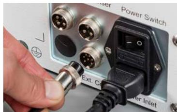
4. Schließen Sie das Eingangs-/Ausgangskabel (E/A-Kabel) am "IO"-Anschluss an.
