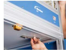
2. Entfernen Sie die vier (4) Schwingungsisolatoren aus dem Gehäuse.
