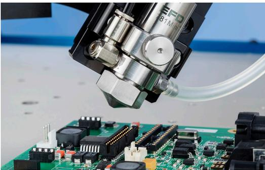
781 Mini-Sprühventil zum Auftragen von Schutzschichten.
