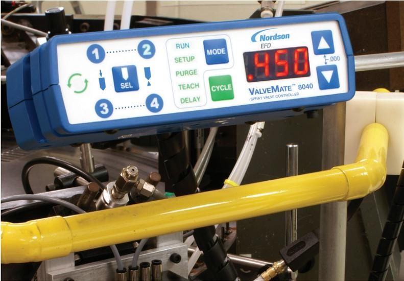
Das Steuergerät ValveMate 8040 ist eine schnelle und bequeme Methode zur Einstellung der Ventilöffnungszeit von Sprühventilen in Schritten von nur 0,001 Sekunden.
