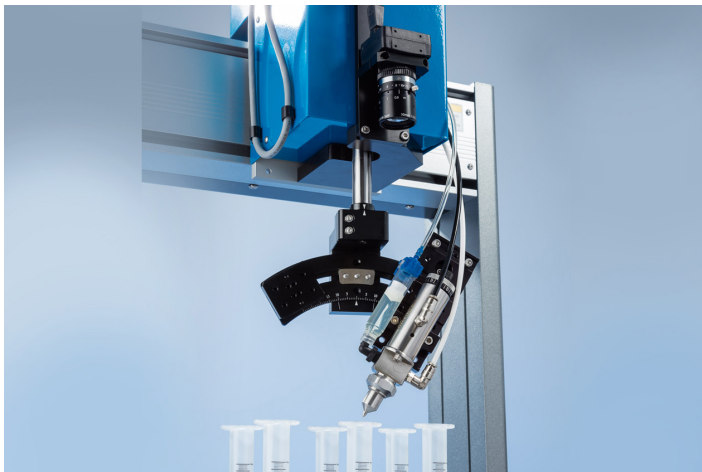
La videocamera CCD smart-vision verifica la presenza e l'orientamento del pezzo.
