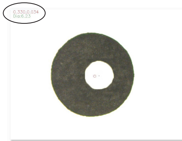
位置チェックに合格しなかったドットの画像の直径の位置とオフセットの詳細
