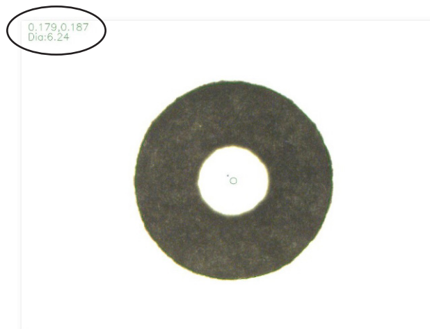
位置チェックに合格したドットの画像の直径の位置とオフセットの詳細
