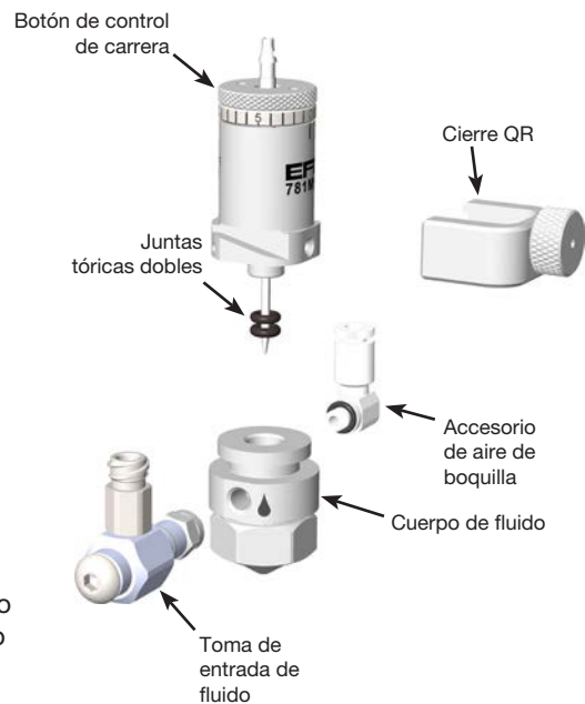
Desmontaje del cuerpo de fluido
