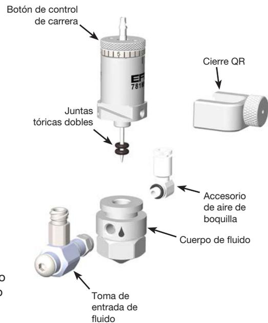
Desmontaje del cuerpo de fluido
