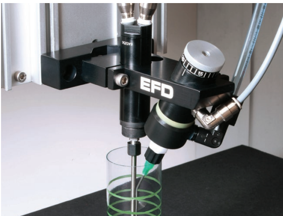
Uma válvula rotativa radial a revestir paredes internas
