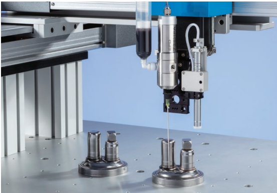
A válvula 736 dispensa a graxa no componente da bomba de combustível.
