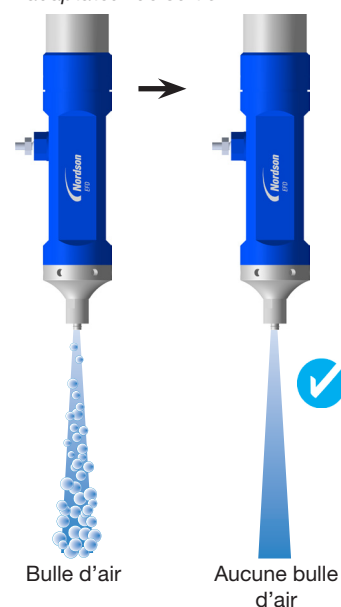
Purge d'une pompe à travers l'adaptateur de sortie
