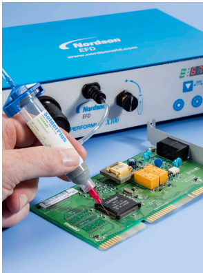
PCB 보드에 SolderPlus® 솔더 페이스트 디스펜싱.
