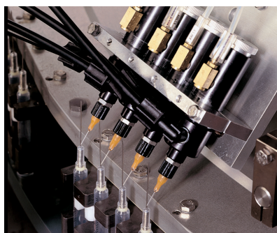
Valvole 741V dosano materiale a polimerizzazione UV su componenti per utilizzo medico.
