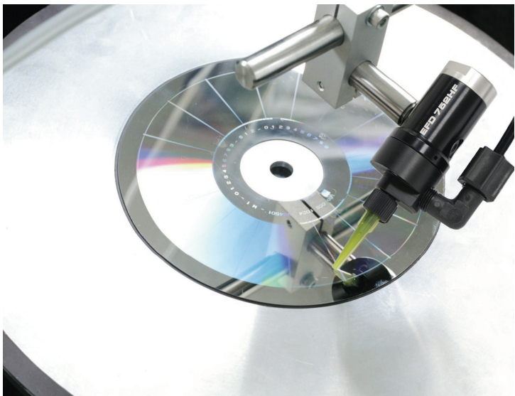
Das 752HF wird bei der Herstellung von Blu-Ray-DVDs und anderen Medien verwendet.
