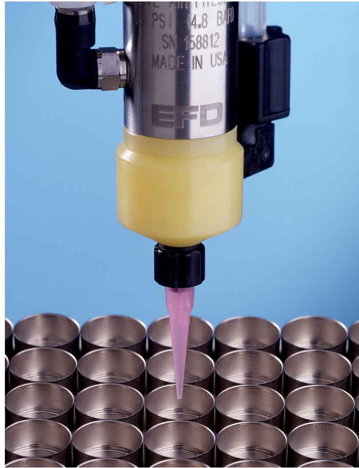
诺信EFD的精准填充系统为填充和去尖应用提供自动解决方案。
