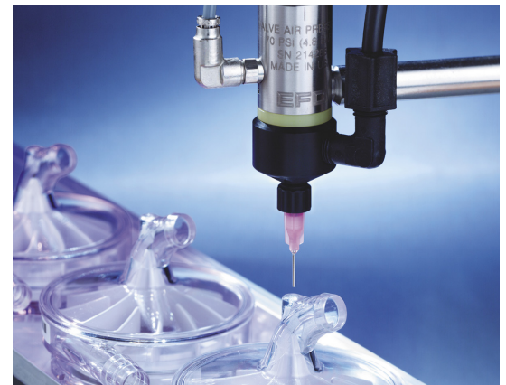
752V dispensando adhesivo de curado ultravioleta en una bomba médica.
