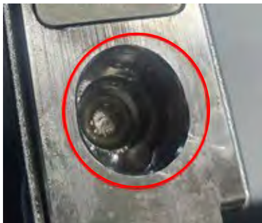
ブッシュロッドキャビティにUV接着剤が混入したPulseバルブアクチュエータの例
