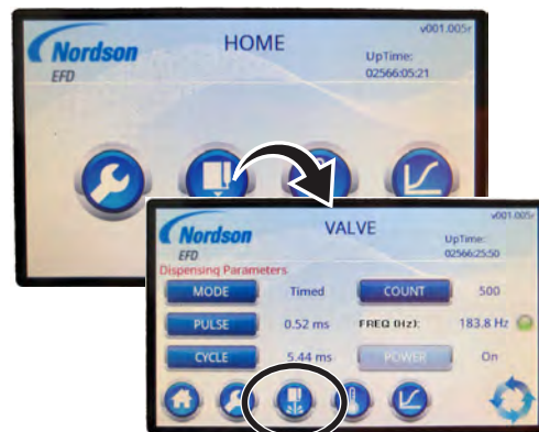
[PURGE]ボタンの位置 (標準TouchコントロールのVALVE画面が表示されています)
