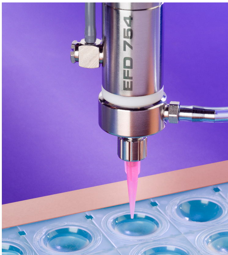
La valve 754V-SS remplissant les emballages de lentilles de contact avec une solution saline.
