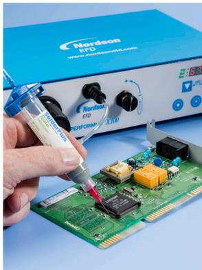
Dosificación de pasta de soldar SolderPlus® en circuitos impresos.
