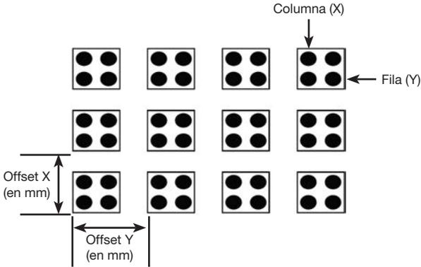
*Ejemplo de offsets X e Y en un comando Paso y repetir*
