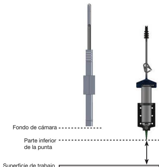
*Ejemplo de instalación correcta de la cámara (punta dosificadora en un nivel inferior respecto a la parte inferior de la cámara)*
