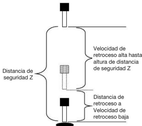
Ilustración de ejemplo de la Configuración de Fin de dosificación
