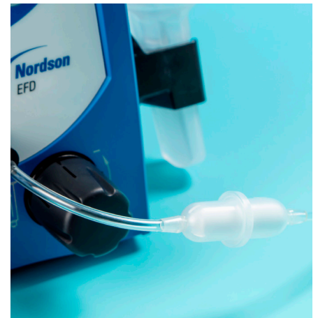
Usate un insieme adattatore con filtro separatore per evitare il risucchio.
