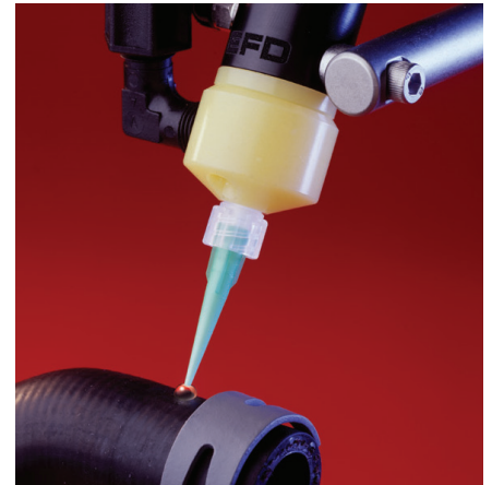
La scelta dell'ago è fondamentale per il successo dell'applicazione di cianoacrilato.
