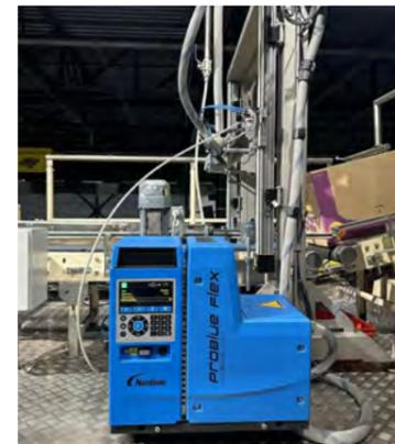
„Das ProBlue-Schmelzgerät ist modular aufgebaut, damit es individuell an die Erfordernisse des Anwenders angepasst werden kann“, erläutert Erik van Gulik, OEM & Key Account Manager bei Nordson. Das Gerät zeichnet sich durch eine schnelle Aufheizzeit aus und kann optional mit einem Klebstoff-Tracking-System ausgestattet werden, bei dem Anwender das Volumen und die Applikation des Klebstoffs einfach messen und überwachen können.
