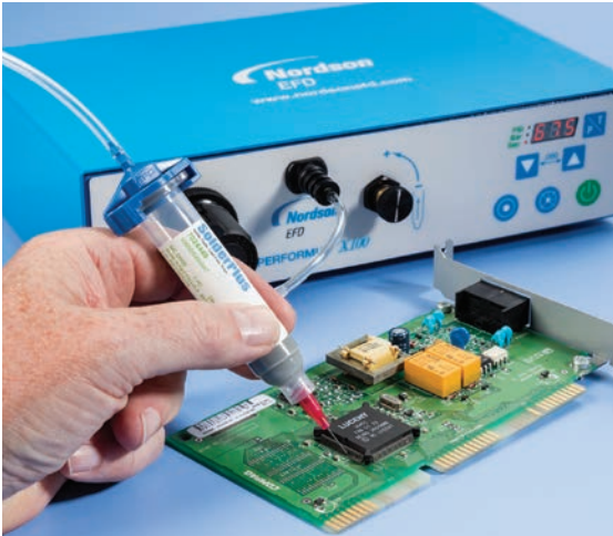
Performus X garantisce un eccellente controllo di processo nelle applicazioni di pasta saldante.
