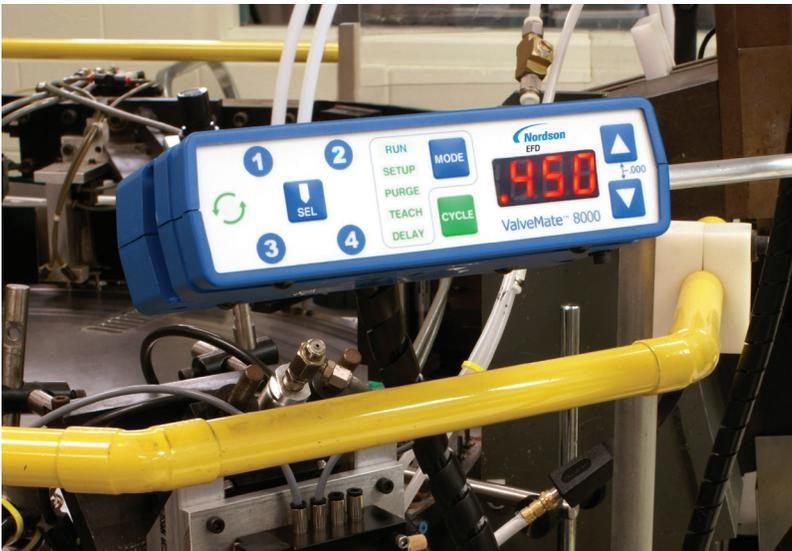
Los controladores ValveMate proporcionan el control principal del tamaño del depósito.
