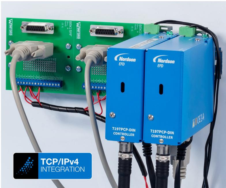
Le contrôleur 7197PCP-DIN-NX intègre le protocole NX via Ethernet pour l'intégration Smart Factory.
