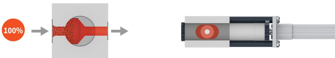
Das beheizte Stahlgehäuse nimmt einen quer zum Schmelzestrom verschiebbaren Siebbolzen mit einer Siebstelle auf. Der Massestrom wird über die Siebstelle geleitet.
