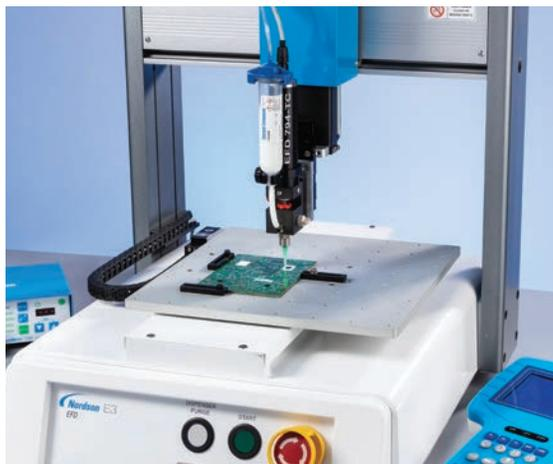
794-TCバルブは熱伝導性材料を、高い精度と再現性で塗布
