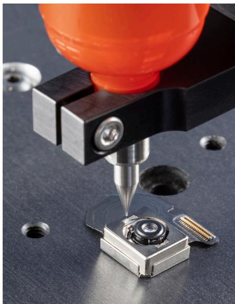
Micro-déposes sur un module compact de caméra.
