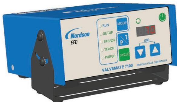
用通用固定架(已随机在内)将控制器装在柜子的上方或下方。固定架可以允许控制器从水平位置旋转30°。如果安装在工作台的下方,要使用可支撑14lbs的螺丝或螺母和螺栓固定。
